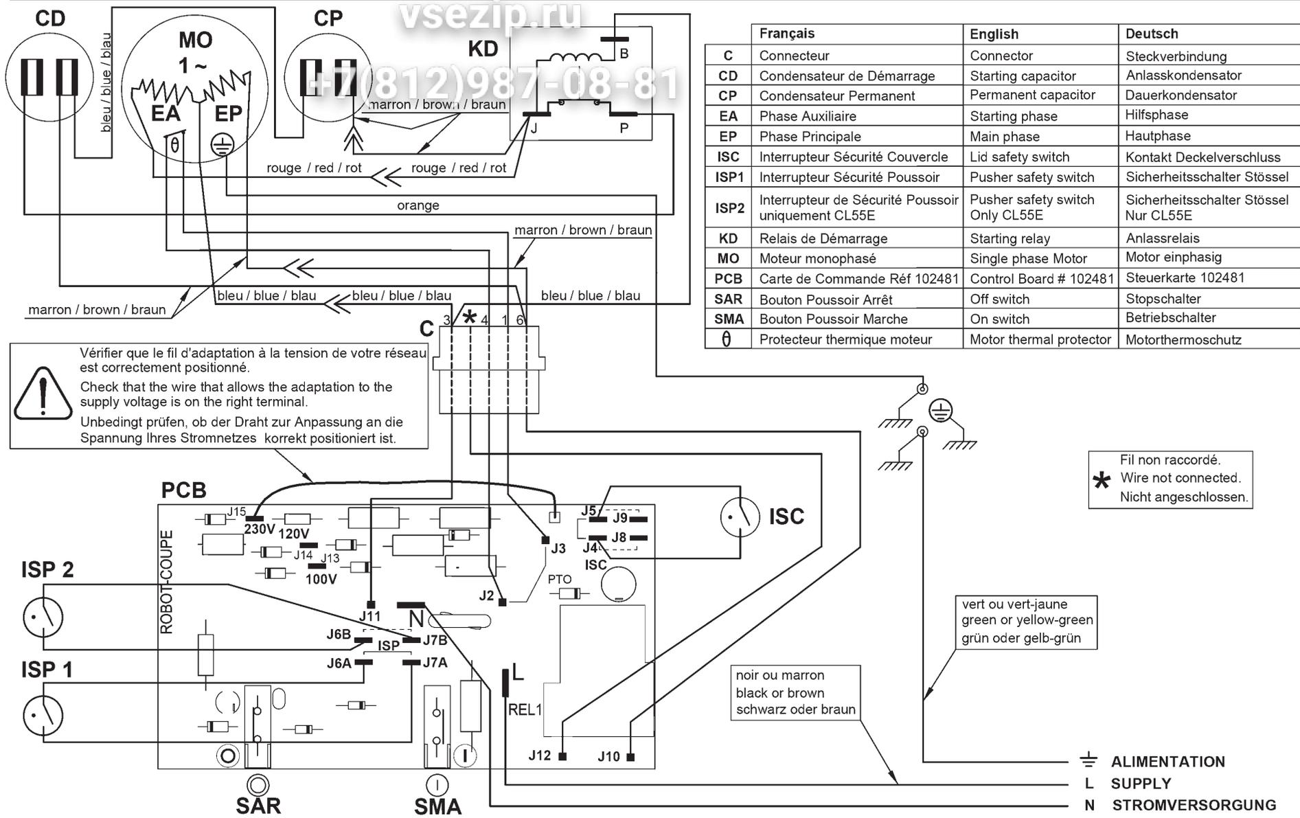
**!** Vérifier que le fil d'adaptation à la tension de votre réseau est correctement positionné.
