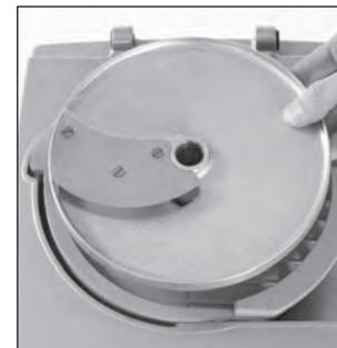
Установите затем соответствующий диск-мельчитель и прокрутите его в направлении часовой стрелки, чтобы проверить правильность его установки.
