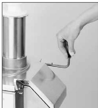
❷ Вставьте **стержень шарнира** в предусмотренное для него место сзади моторного блока. Закрепите крышку на моторном блоке с помощью крепёжной лапки.
