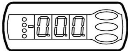
На лицевой панели находится трехразрядный цифровой индикатор для отображения температуры, выбранных значений функций меню или аварийных/сервисных сообщений, а также светодиоды, которые загораются при активации соответствующих им реле (охлаждение/оттайка). При нормальной работе отображается температура датчика Saig.
