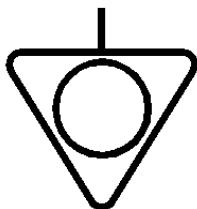
Рисунок 3 – Знак эквипотенциального заземления
