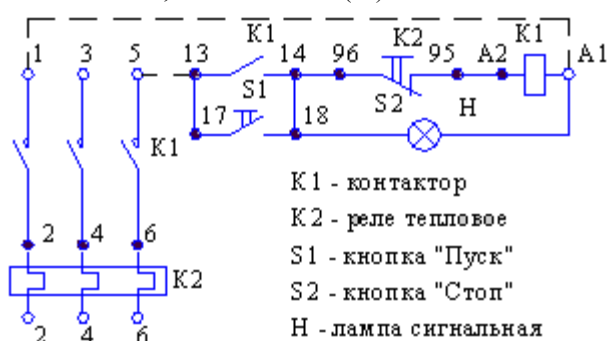
Рис. 2.18 – Пускатели нереверсивные типа ПМ12-025, ПМ12-040 с реле в оболочках степени защиты IP40, IP54
