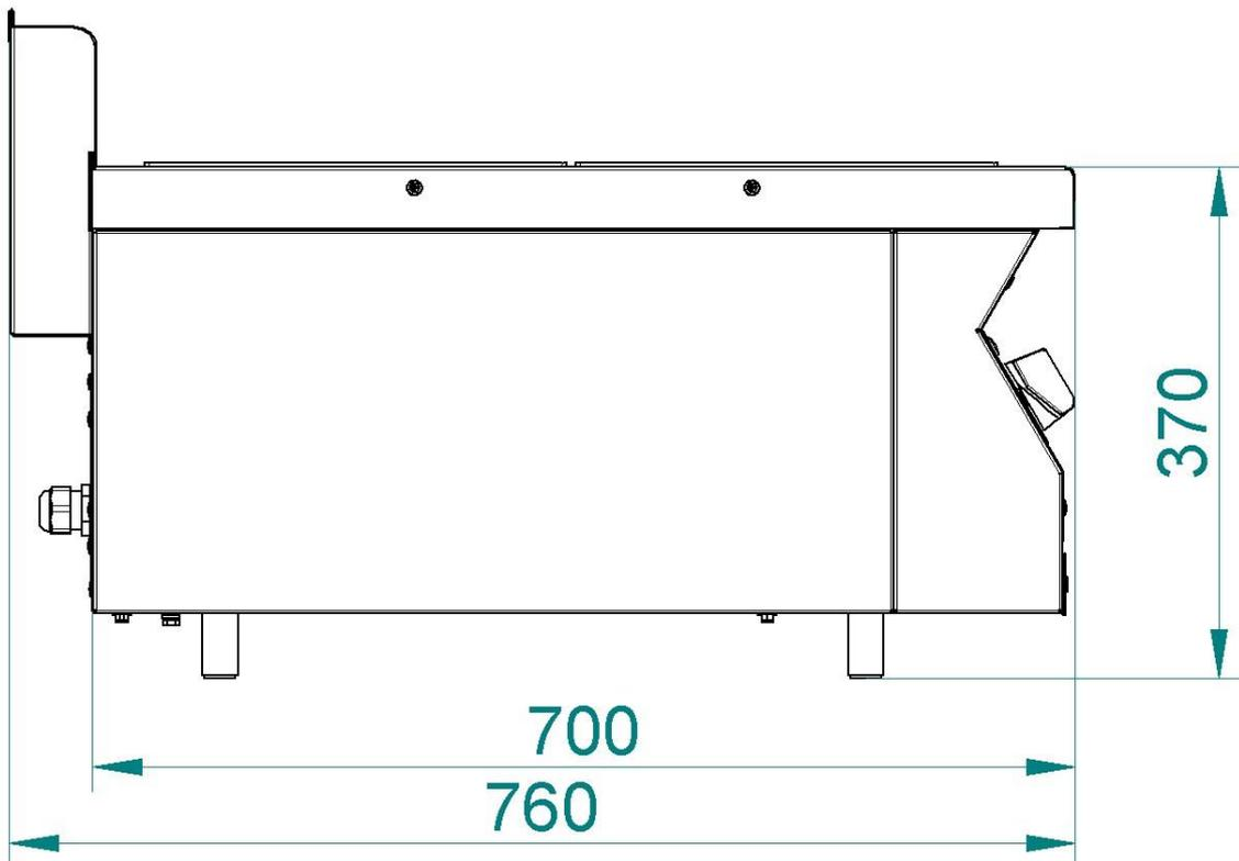
Рис. 10 Плита электрическая ЭПК-27Н, ЭПК-47Н (вид сбоку)
