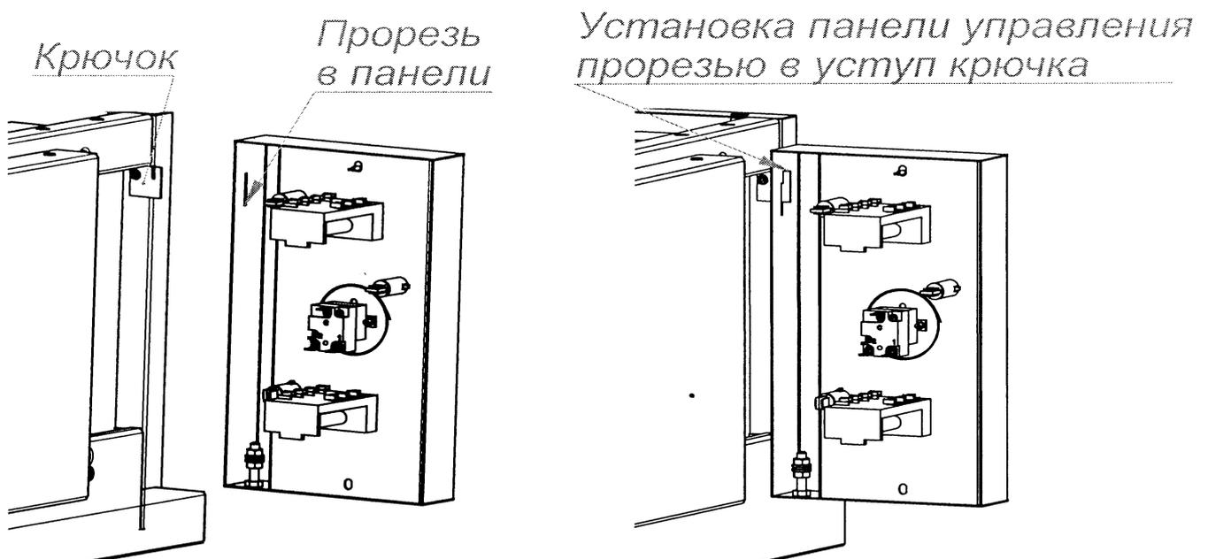
Рис. 8 Схема установки панели управления при ТО
