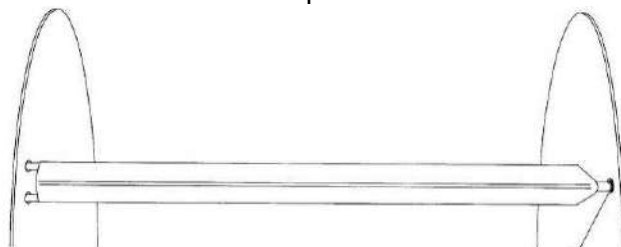
Position des Spießes mit der Nut am Ende des Spießes in den Löchern der Ronden
