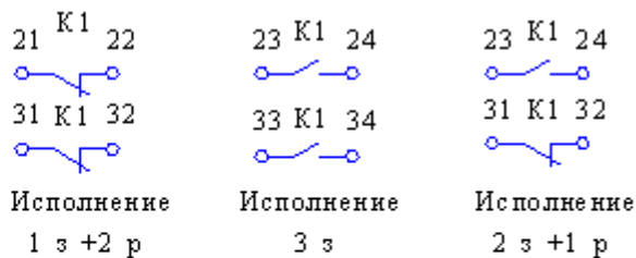
Рис. 2.4 - Пускатели нереверсивные с реле со встроенными в оболочку кнопками управления типа ПМ12-010260, ПМ12-010220 (1"з")
